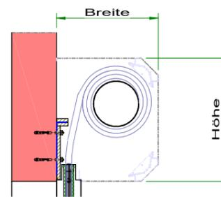
**Sonderlösung für Einbau in Zwischendecke**
