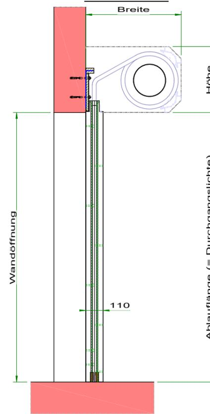
**Textil Flexibler Feuerschutzabschluss geprüft nach EN 16034 und EN 1634-1**
